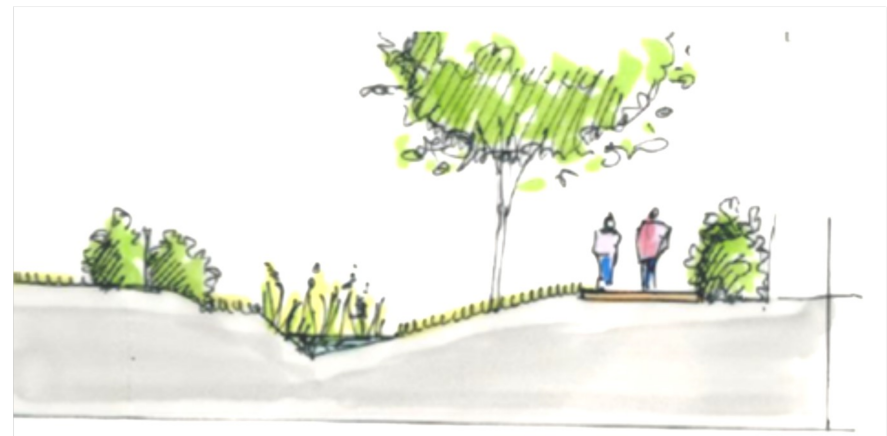
Coupe de principe d'une noue en entrée de quartier
