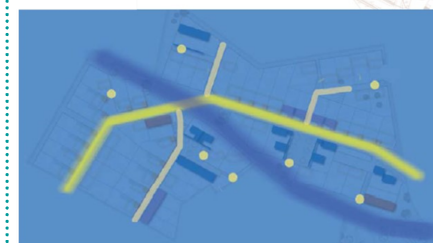
Exemple de principe de hiérarchisation de l'éclairage public (ZAC du Petit Riz à Souvigné-37)
