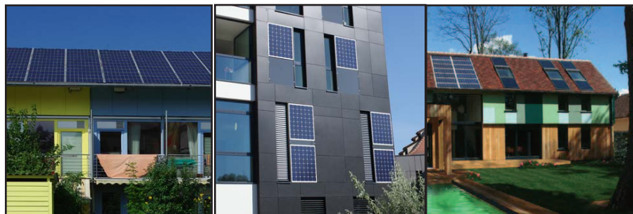
Illustrations : exemples d'intégration des panneaux solaires dans la toiture ou la façade
